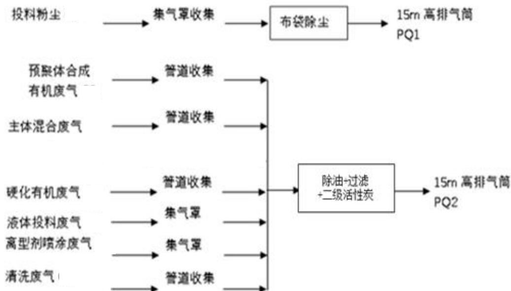
图 2.4-3 项目废气收集处理方式
